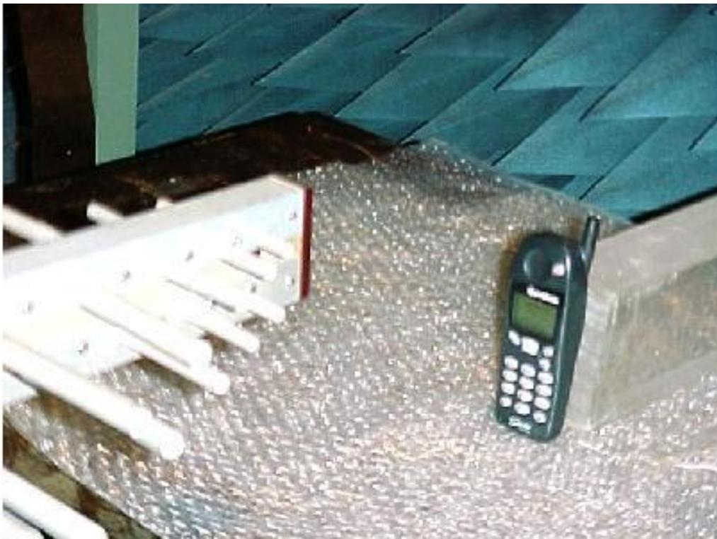
Figura 16 - Foto da disposição da antena e telefone celular durante o ensaio.
