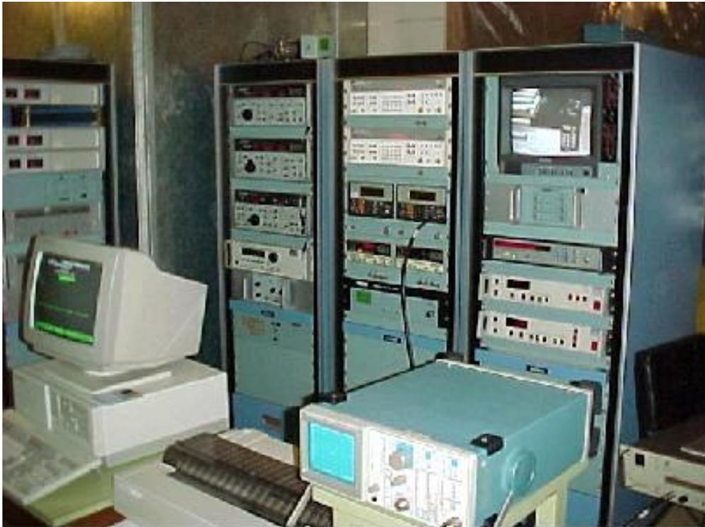
Figura 15 - Sistema de teste utilizado para a verificação do campo elétrico.
