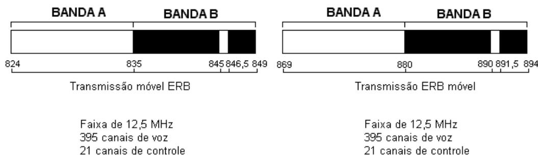
Figura 4 - Divisão do espectro de frequência para a telefonia móvel.
