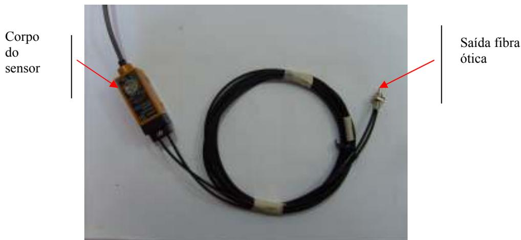
Figura 3.5 Sensor de posicionamento com fibra ótica
