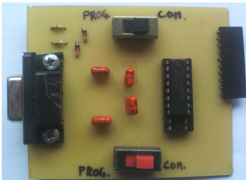
Figura 3-12 – Foto da placa de comunicação/programação serial
