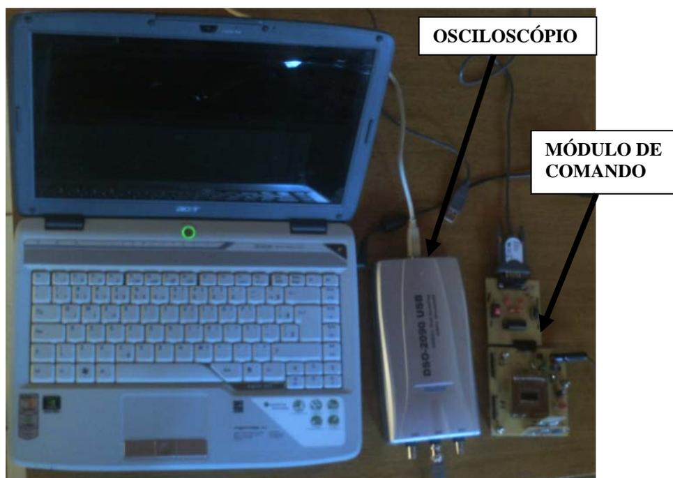
Figura 3-26 - Módulo de comando e osciloscópio
