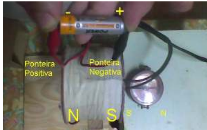
Figura 24- Criando campo em bobina com pilha
