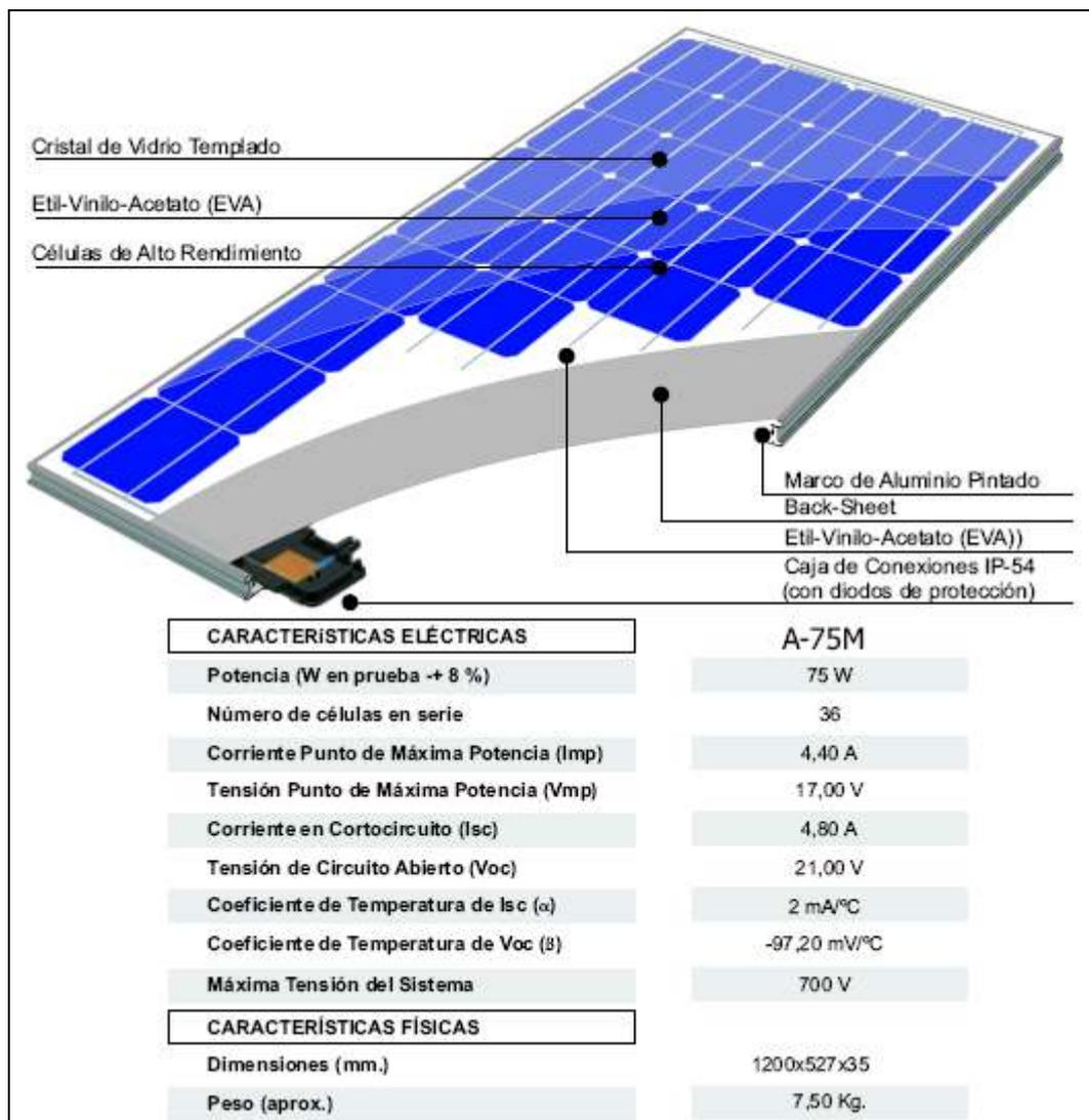
Figura 3.2 - Dados Construtivos do Gerador A-75M [Catálogo de Produto [www.atersa.com](http://www.atersa.com)]
