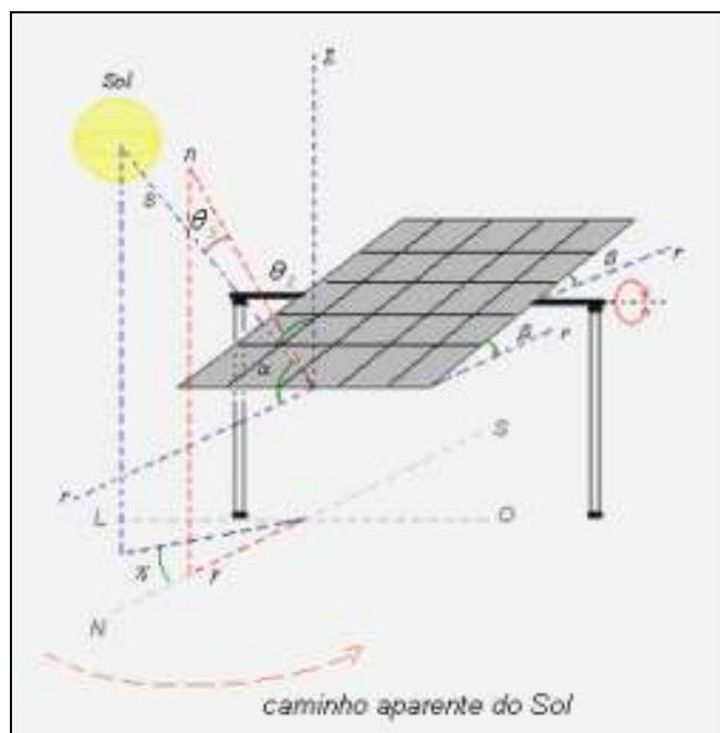
Figura 3.4 - Modelo de seguidor com eixo orientação leste-oeste [OLIVEIRA, Maurício, Madeira *Análise do Desempenho de um Gerador Fotovoltaico com Seguidor Solar Azimutal*, Programa de Pós Graduação em Engenharia Mecânica. UFRGS, 2008]
