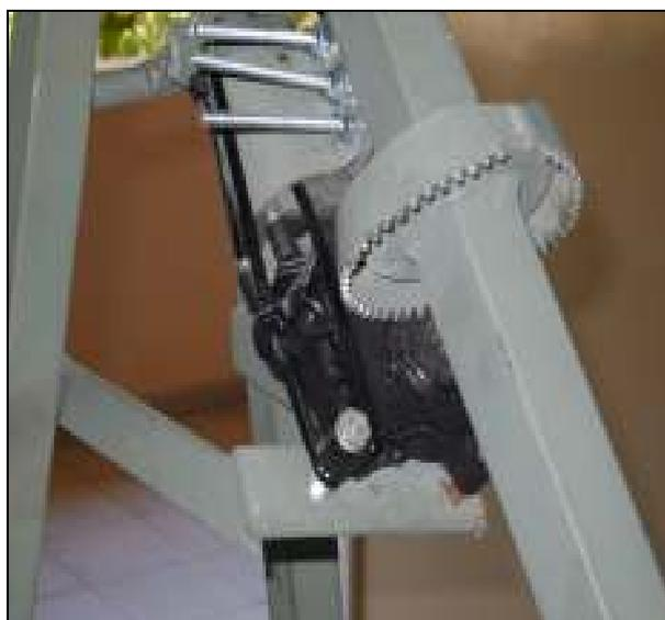
Figura 4.4 - Detalhe Motor com engrenagem adaptada a partir da cremalheira existente no motor.
