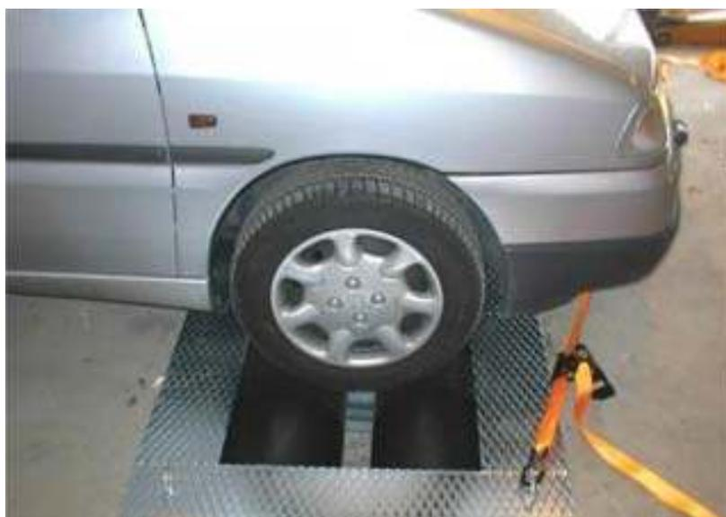
Figura 2.9 – Carro sobre dinamômetro de rolos (Fonte: Esther Turbo)
