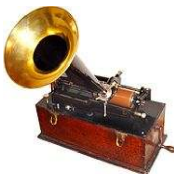
Figura 1 – Fonógrafo de Edson (diafragma ligado à corneta)
