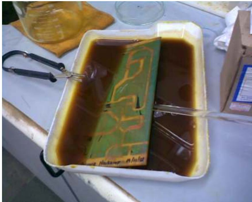
Figura 18 – Etapa de corrosão da placa fenólica
