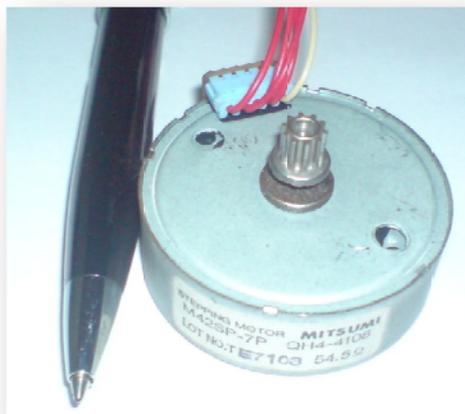
Figura 17 - Motor de Passo.
