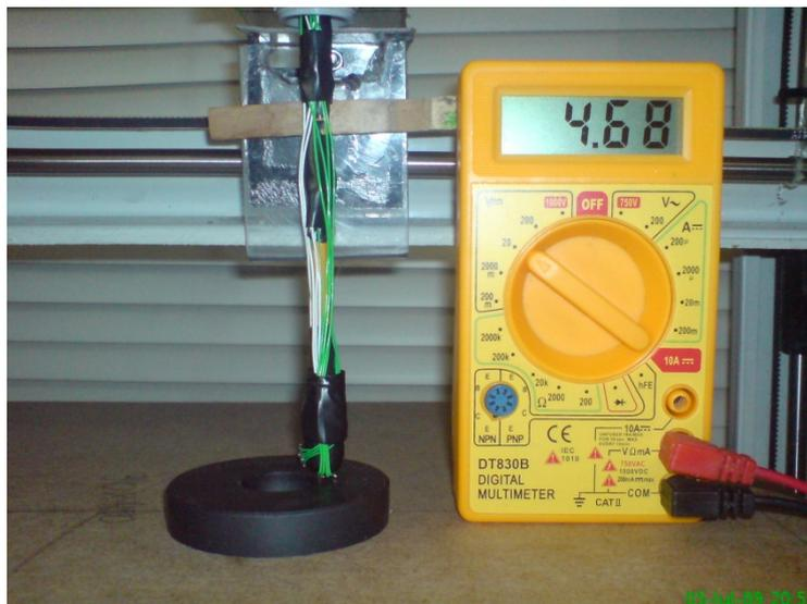
Figura 45 - Sensor com Distância Zero do corpo de prova.
