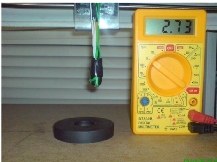
Figura 46 – Sensor a 40mm do corpo de prova.
