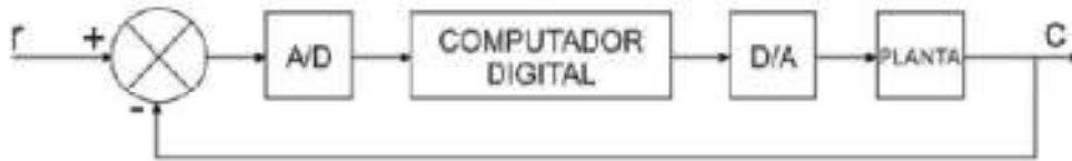
Figura 2-11 - Diagrama em blocos do controlador digital. Fonte: NISE, 2002.
