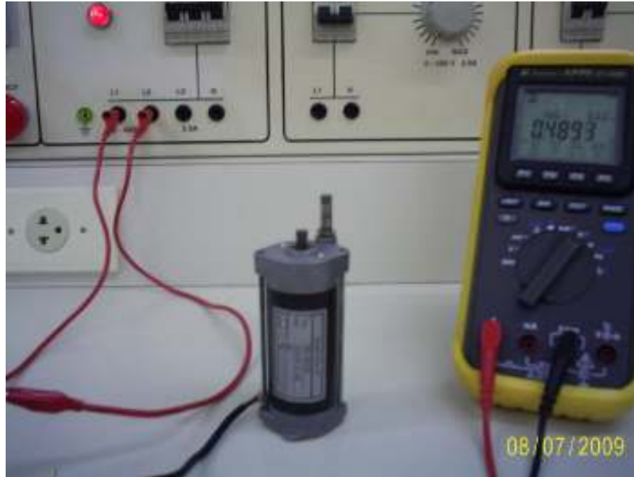
Figura 3-7- Valor da corrente obtido no ensaio para medida da indutância total das bobinas
