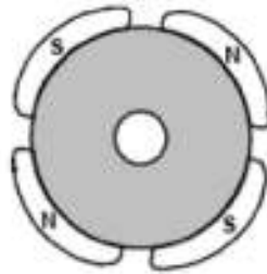
Figura 2-1 - Rotor circular de um motor Brushless de quatro pólos Fonte: AN855 Microchip (2003)
