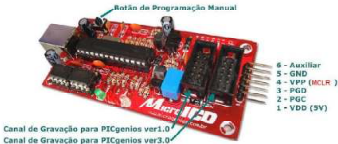
Figura 3-17- Gravador MicroICD da Microgenios
