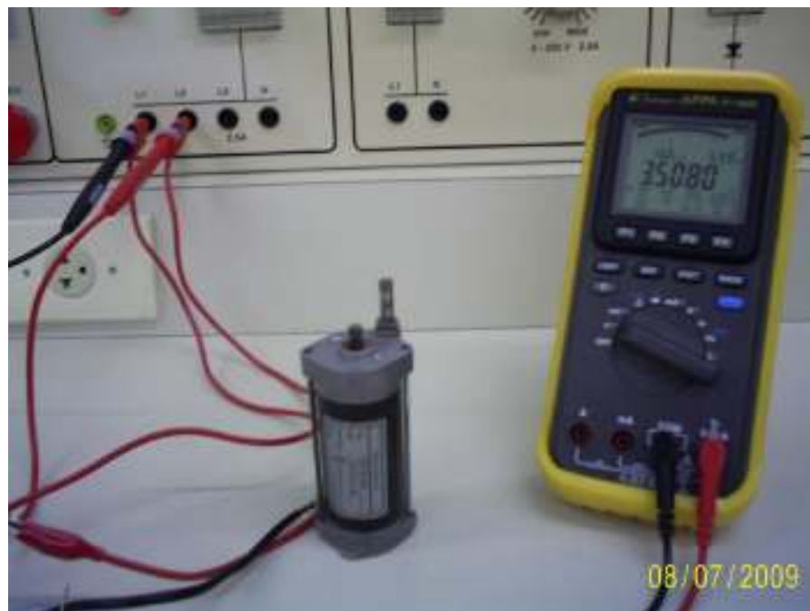
Figura 3-6- Tensão aplicada às fases B-C no ensaio para medida da indutância total das bobinas
