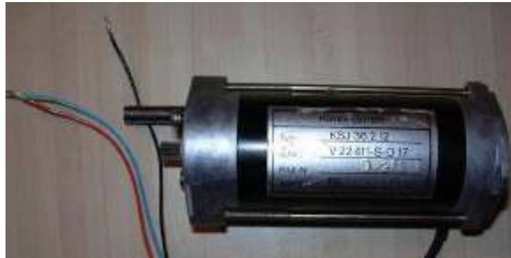
Figura 3-2- Motor Brushless DC Trifásico utilizado na implementação do projeto
