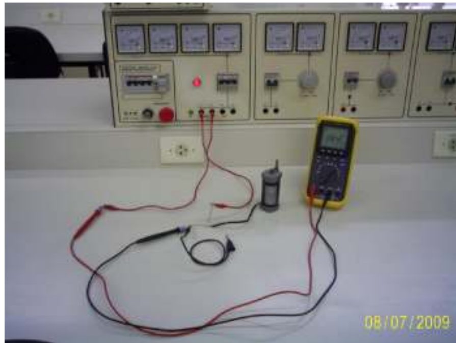
Figura 3-5 - Visão geral do ensaio para medida da indutância das bobinas
