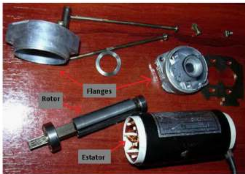
Figura 3-3- Visão geral da estrutura do motor
