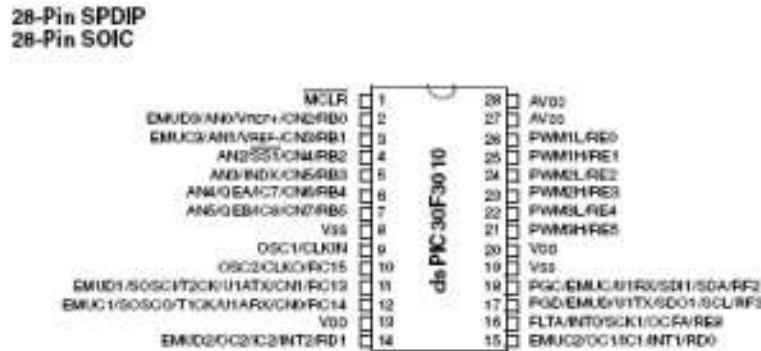
Figura 3-12- Diagrama de Pinos do DSPIC30F3010 Fonte: Datasheet do componente dsPIC30F3010 (2005)
