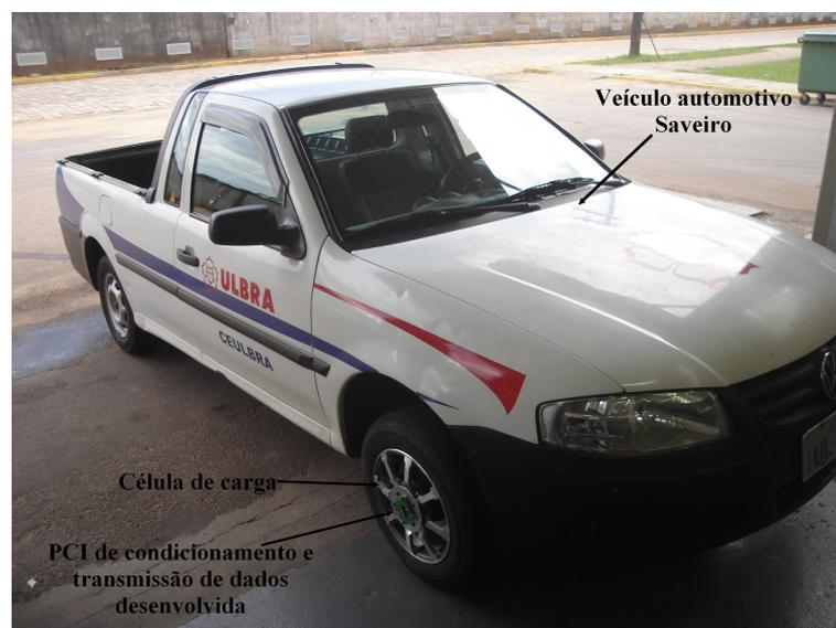
Figura 4.3 – Veículo utilizado para realizar os ensaios dinâmicos.
