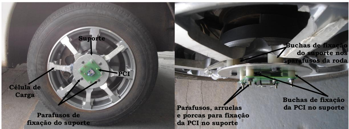
Figura 3-18 – Detalhes da solução embarcada desenvolvida.
