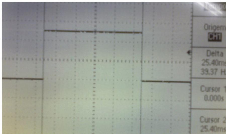
Figura 26 - Sinal do *encoder* após tratamento.
