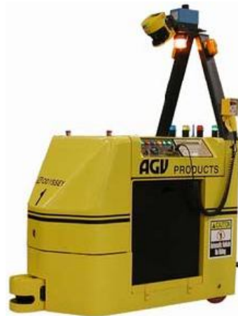
Figura 2-11 - "Odyssey Tugger Vehicle" guiado por sistema laser.
