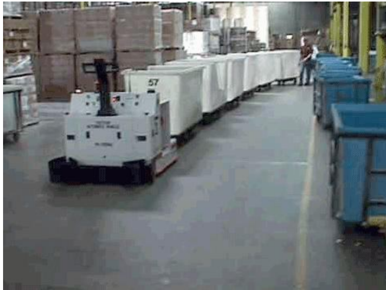
Figura 2-2 - AGV de transporte em "comboio" em um estoque. [Fonte: Egemin Automation - www.egemin.com ]
