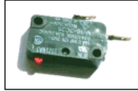
Figura 3-12 - Interruptor NA. [Fonte: Saber Eletrônica - www.sabereletronica.com.br ]
