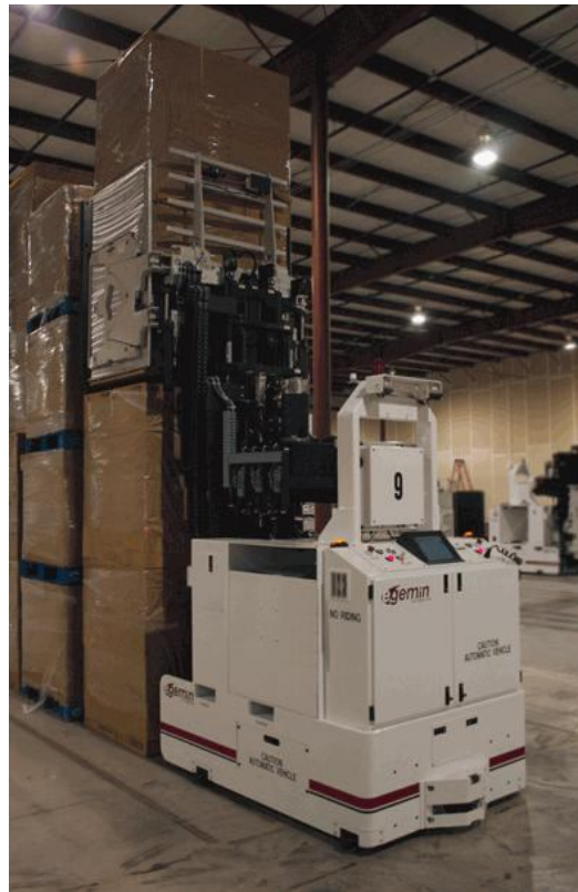
Figura 2-4 - AGV em transito num armazém. [Fonte: Egemin Automation - www.egemin.com ]
