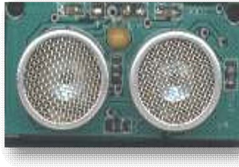
Figura 3-15 - Módulo sonar. [Fonte: Manual do Sensor Sonar- Anexo A]
