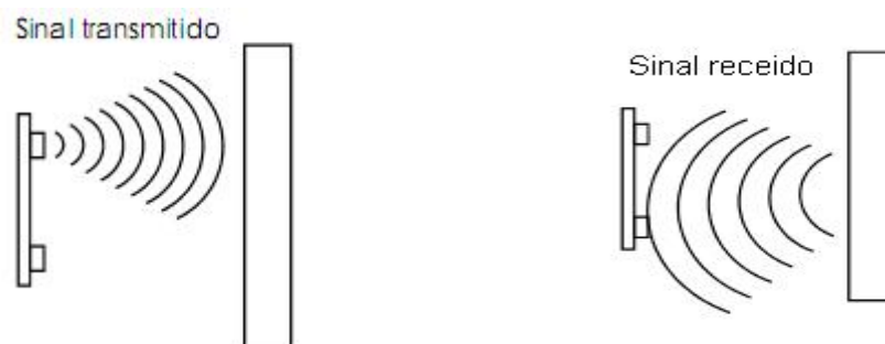
Figura 2-19 - Funcionamento do Sonar [Fonte: Datasheet do sonar- Anexo A]
