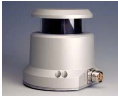
Figura 2-10 - Scanner Laser que envia ao AGV a sua posição e ângulo.
