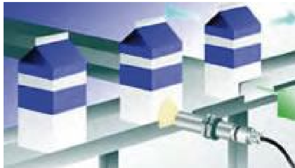
Figura 2-18 - Sensor capacitivo. [Fonte: AGV Eletronics – [12]]
