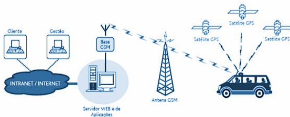
Figura 2-13 – Funcionamento do sistema GPS.
