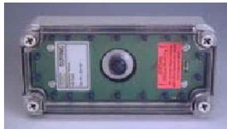
Figura 2-7 - Câmera fotográfica com iluminação artificial. [Fonte: AGV- [10]]
