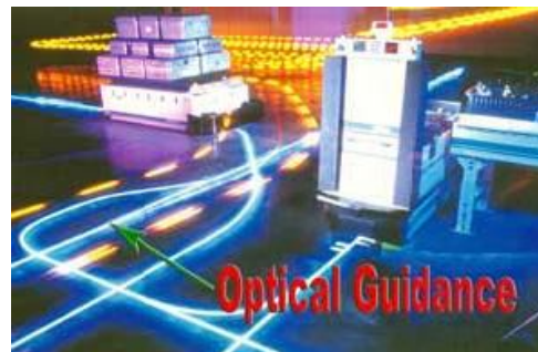
Figura 2-8 - Guias UV. [Fonte: AGV- [10]]
