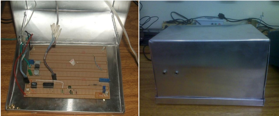
Figura 18 - Condicionador de Sinal
