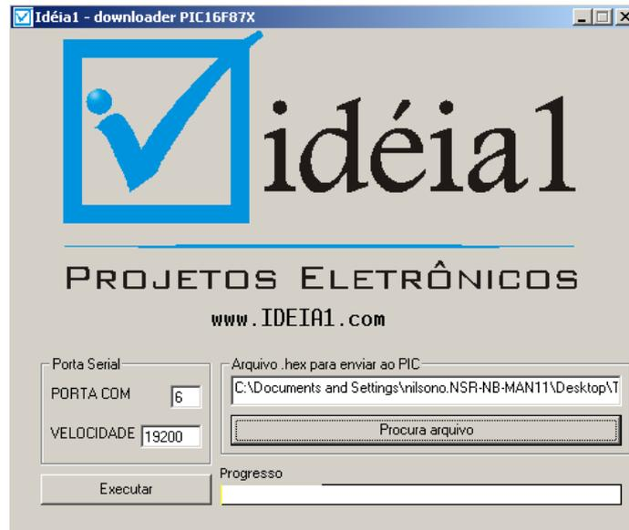
Figura 8 – Software de gravação do programa no pic
