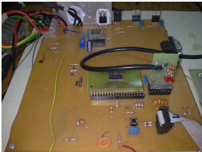
Figura 3.4: Circuito principal - aquisição e comunicação
