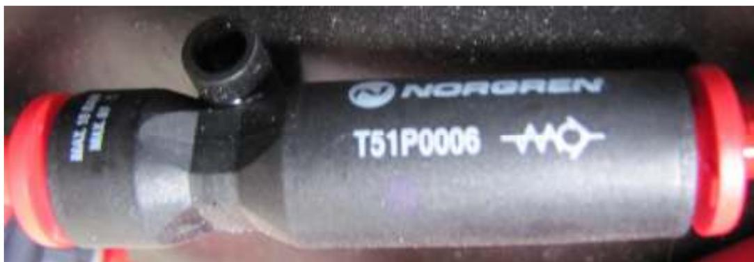
Figura 19 - Válvula de retenção modelo T51P0006 da fabricante Norgren.
