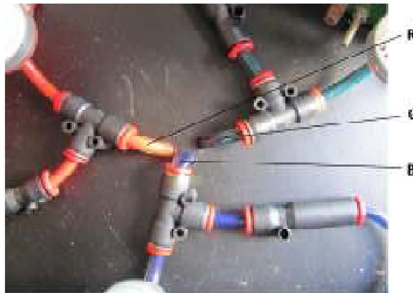
Figura 21 - Válvulas de retenção instaladas na sucção do sistema.
