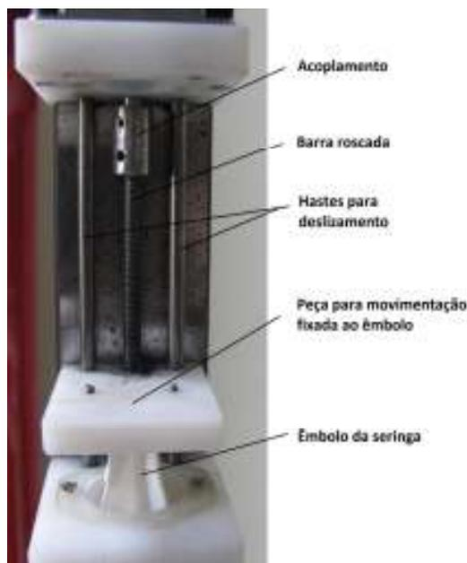
Figura 16 - Estrutura desenvolvida para movimentação do êmbolo
