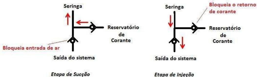
Figura 18 - Esquemático de funcionamento das válvulas de retenção nas etapas de sucção e injeção de corantes.
