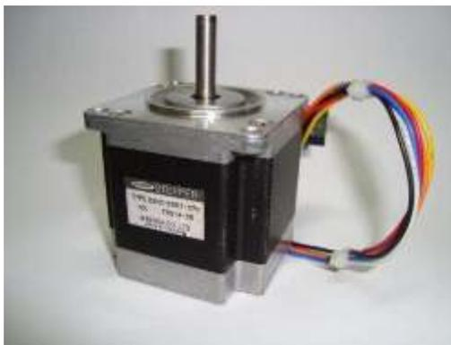
Figura 3 - Motor de passo unipolar utilizado no sistema de dosagem
