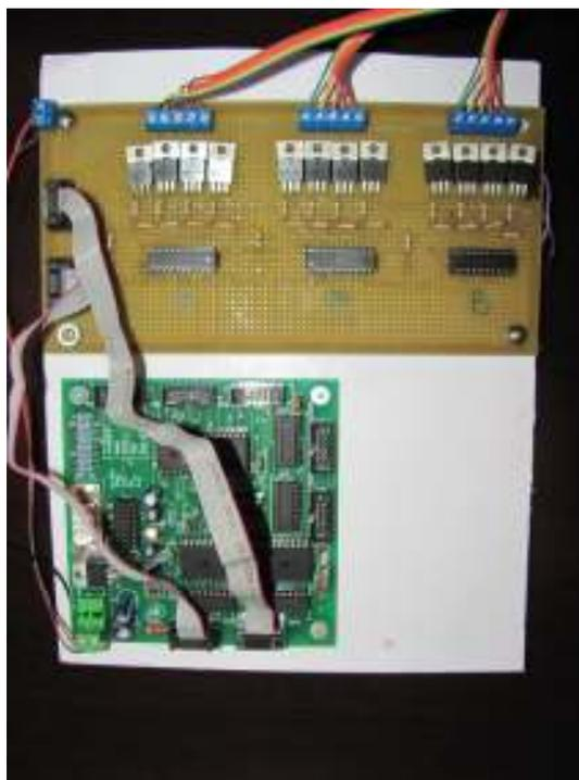
Figura 24 - Kit ULBEE51 conectado ao circuito de potência
