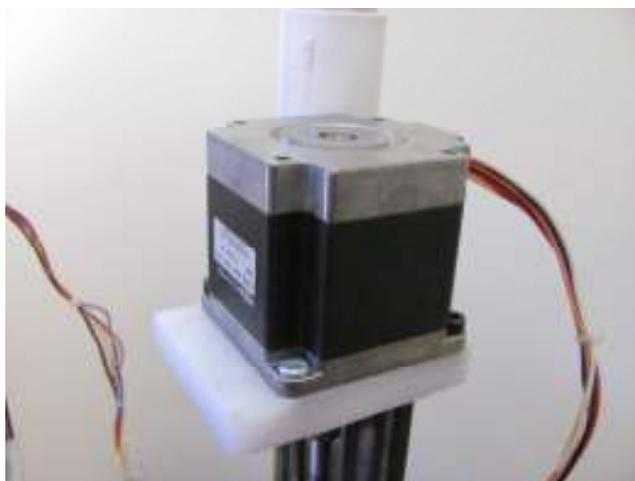
Figura 29 - Motor de passo acoplado ao sistema.
