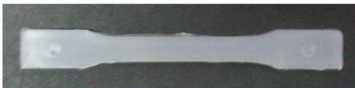
Figura 4.2 – Corpo de Prova Utilizado
