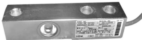
Figura 2.5 - Célula de Carga Tipo I
