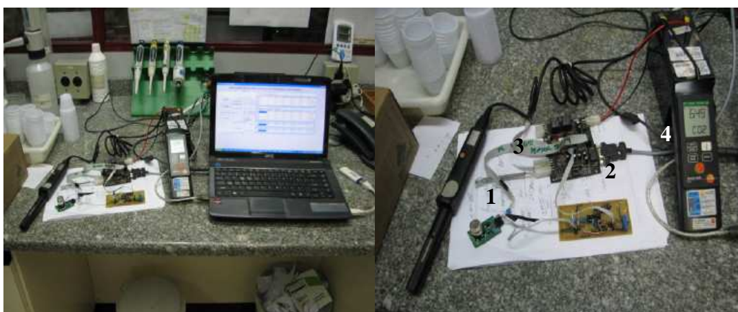
Ilustração 3-60 Calibração do ponto do sensor de CO 2 ; 1- Sensor CO 2 ; 2 – Placa Amplificação ; 3- Placa CPU ; 4 –Medidor calibrado de CO 2
