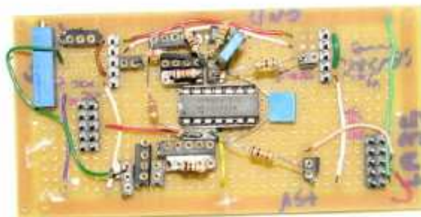
Ilustração 3-27 Foto placa amplificadora do sensor de temperatura e do sensor de CO 2
