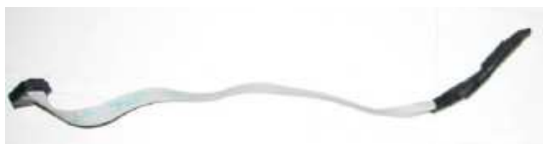
Ilustração 3-24 Sensor de Temperatura LM35 montado
