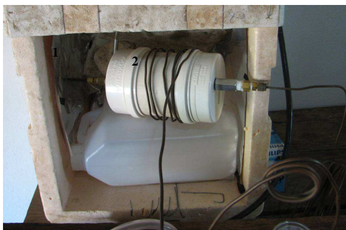
Ilustração 3-11 Estufa (1) e primeiro protótipo do biofiltro(2).
