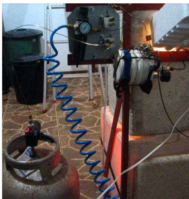
Ilustração 3-6 Entrada do gás de cozinha e ar-comprimido
