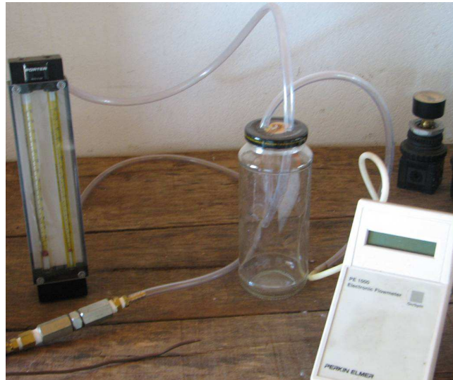
Ilustração 3-7 Na esquerda o Rotâmetro e direita o fluxímetro
