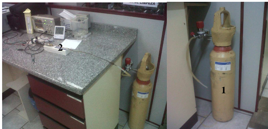
Ilustração 3-59 Calibração de Zero; 1-Cilindro Gás Padrão ; 2- Equipamento desenvolvido
