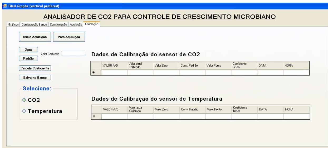
Ilustração 3-50 Tela de calibração dos dois sensores
