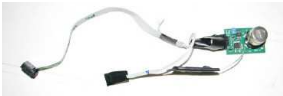
Ilustração 3-28 Sensor e placa pré-amplificadora
