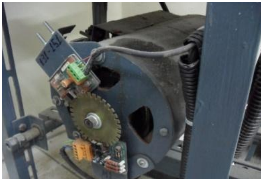
Figura 2-14 Foto Sistema de leitura de rotação utilizado nos motores do Simulador
