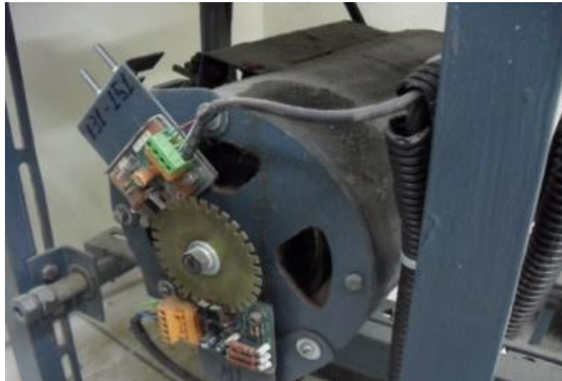
Figura 3-11 Sensor de velocidade usado nos motores
