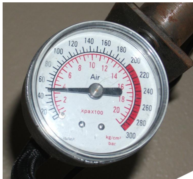
Figura 4.1- Manômetro utilizado para aferir o transdutor e comparar os resultados Fonte- O autor
