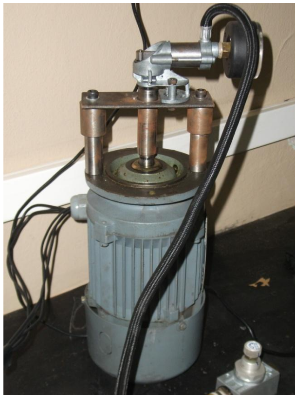
Figura 3.3- Detalhe do acoplamento do motor de indução no compressor Fonte - O autor
