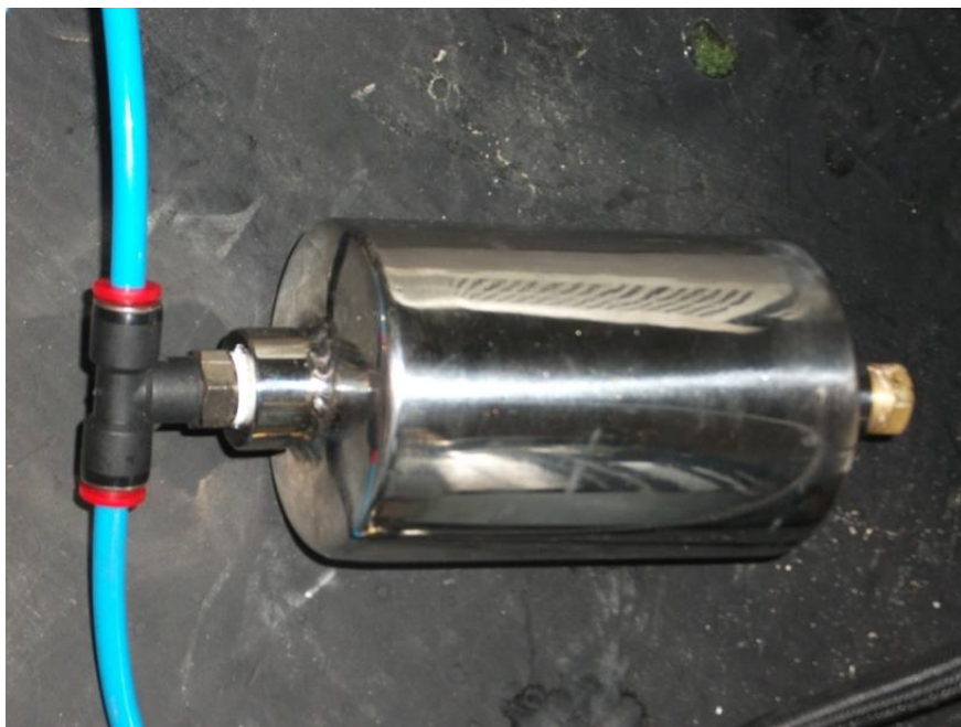
Figura 4.6- Reservatório de ar Fonte- O autor
