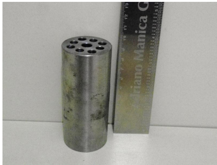
Figura 40 – Núcleo com 9 furos usinado
