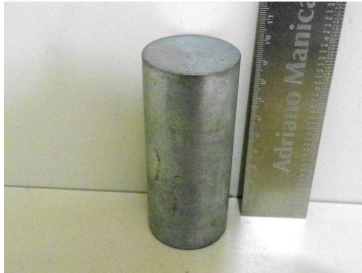
Figura 36 – Núcleo maciço usinado
