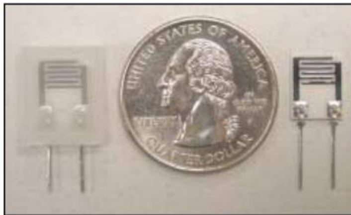
Figura 20: Sensor de umidade relativo resistivo UPS 500 [12].
