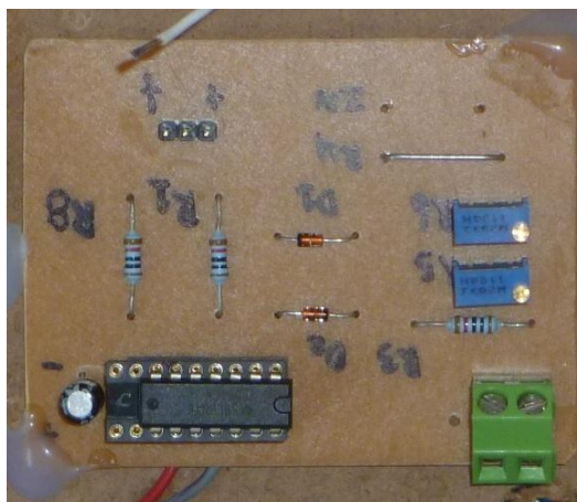
Figura 29: Circuito montado do Retificador de precisão com amplificador operacional
