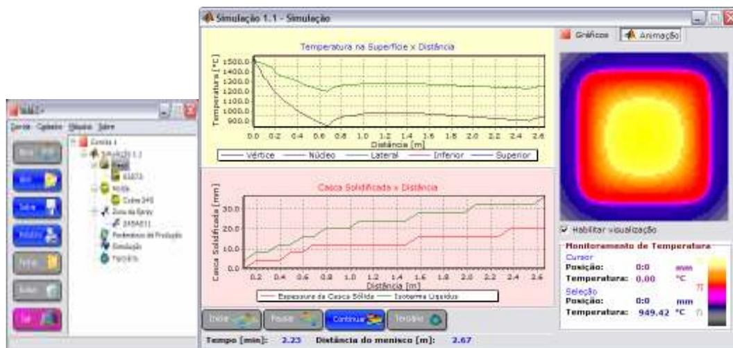
Figura 6-36 - Simulação de resfriamento de tarugos de aço no lingotamento contínuo (Software InALC+ - Cortesia LAFUN – UFRGS)
