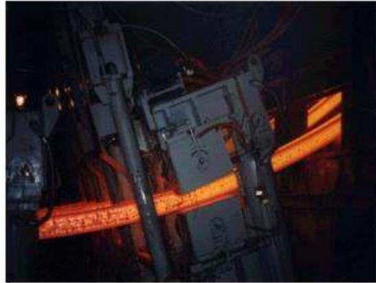
Figura 6-21 – Máquina de Lingotamento Contínuo.
