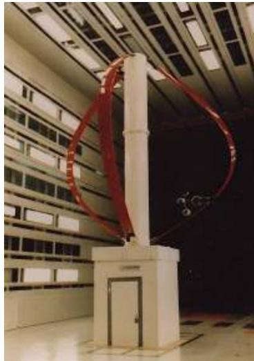
Figura 6-32 - Modelo em escala para simulação de um gerador eólico (cortesia de Pininfarina ARC).
