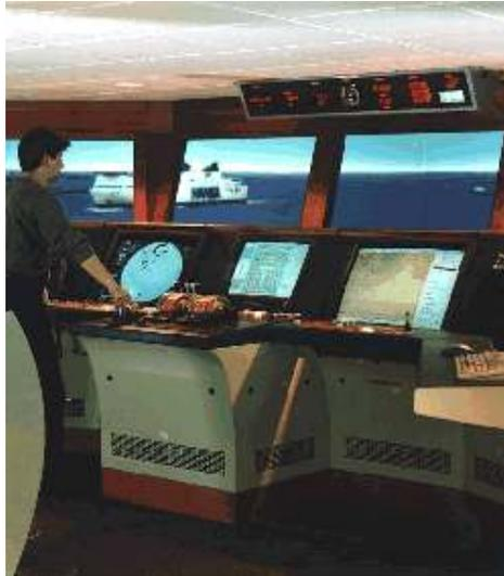
Figura 6-49 – Simuladores para treinamento de pilotos de grandes barcos (Cortesia de Real Sims Inc.)<sup>39</sup>
