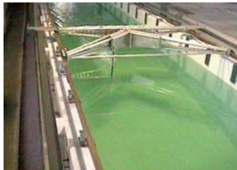
Figura 6-29 – Canal de testes para ensaios físicos de hélices e carenas (cortesia do Instituto de Pesquisas Hidráulicas da UFRGS)
