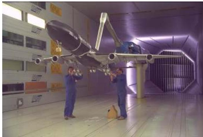
Figura 6-27 - Preparação para simulação de um modelo em escala do Airbus A380 (cortesia de German-Dutch Wind Tunnels DNW)
