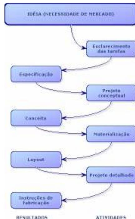
Figura 5-9 – Modelo do processo de projeto
