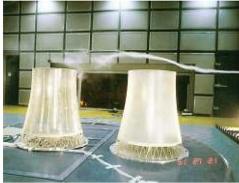
Figura 6-28 – Simulação do escoamento de ar em um modelo em escala de torres de resfriamento (cortesia de Pininfarina ARC<sup>35</sup>)
