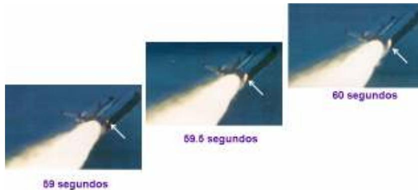
Figura 3. A nave espacial Challenger, desde os 58 aos 60 segundos depois da decolagem (28 de enero de 1986). No foguete direito inicia uma chama que primeiro fica visível e depois se espalha até o tanque.
