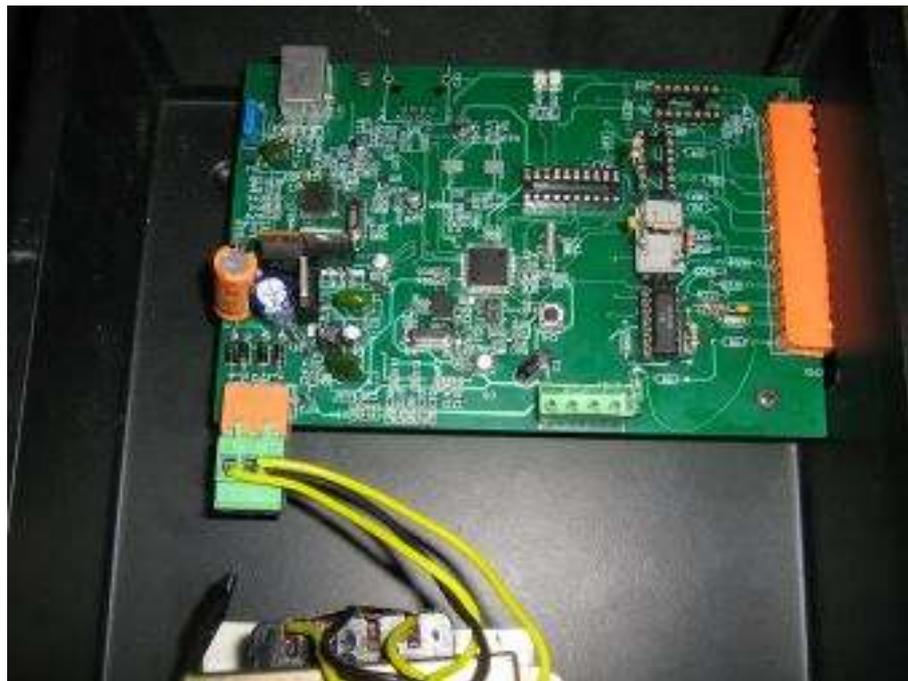
Figura 15 - Placa de aquisição dedicado
