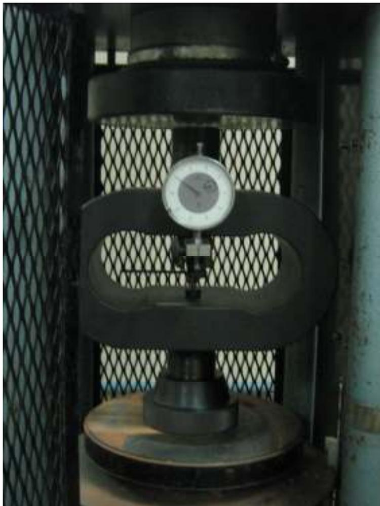
Figura 26 - Célula de carga no mecanismo para calibração
