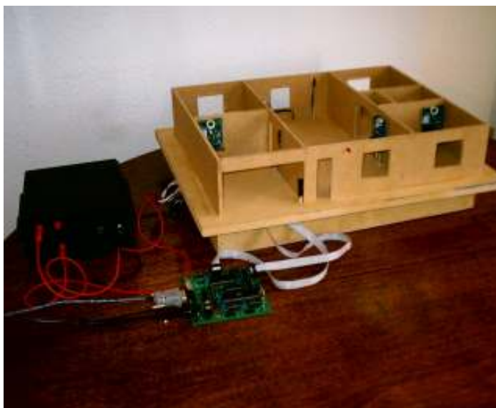
Figura 6 – Montagem completa do sistema de Automação Residencial proposto.
