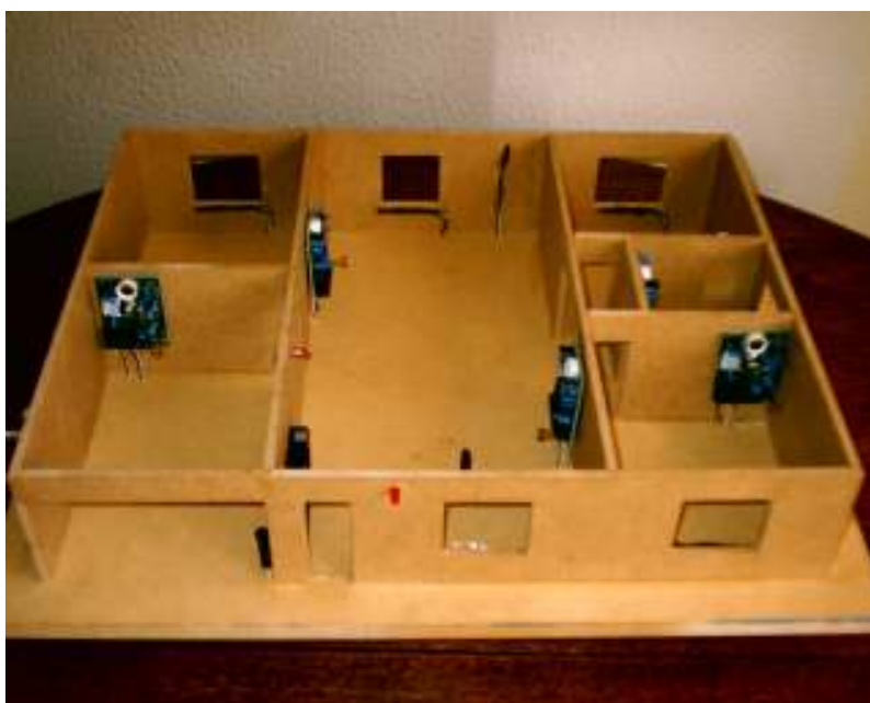
Figura 4 - Maquete com sensores e acionadores instalados.
