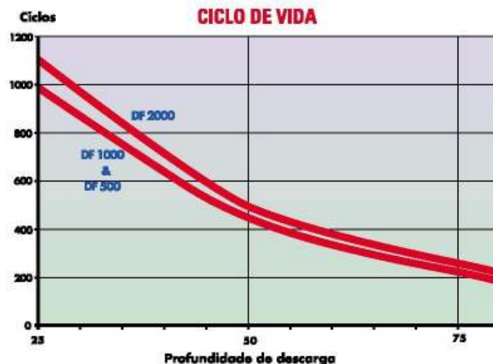
Figura 4 – Número de ciclos de carga de baterias estacionárias em função da profundidade de descarga.
