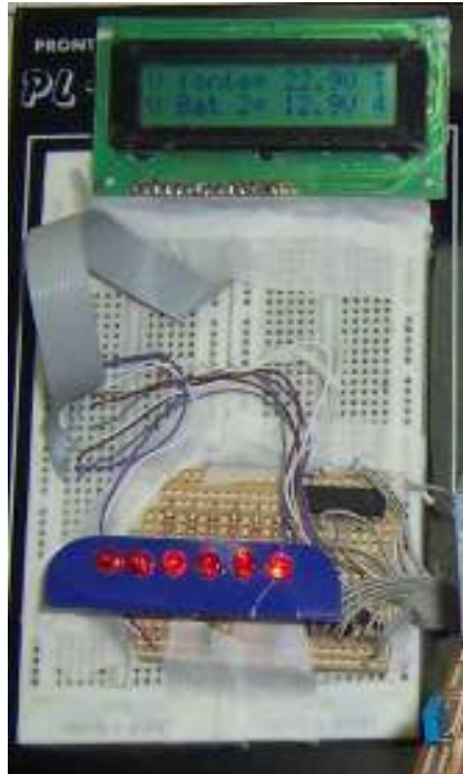
Figura 20 – Montagem no protboard do LCD e Led de monitoramento das baterias.
