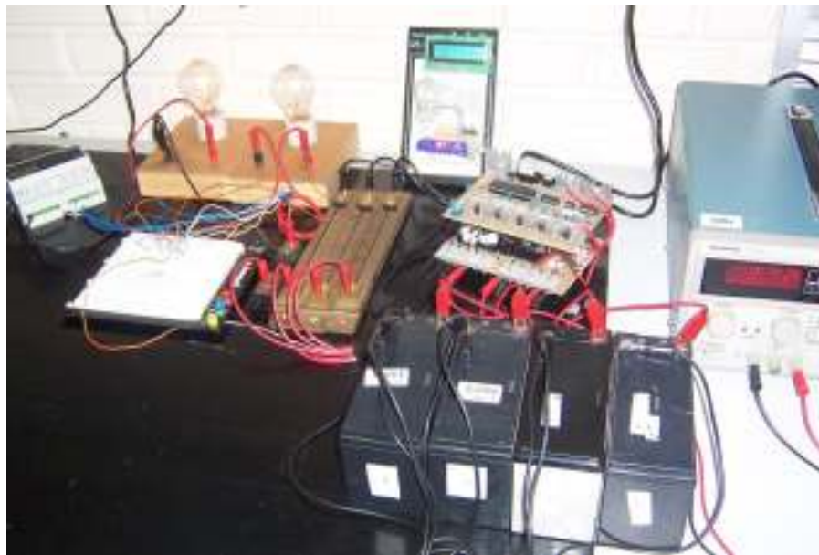
Figura 23 – Teste do controlador com cargas consumidoras e baterias.
