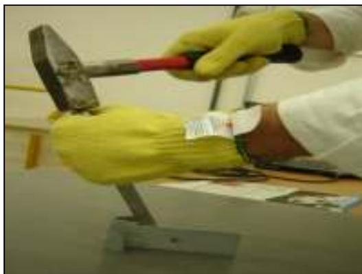
Figura 1.3 - Imagem de teste de solda manual em corpo de prova padrão
