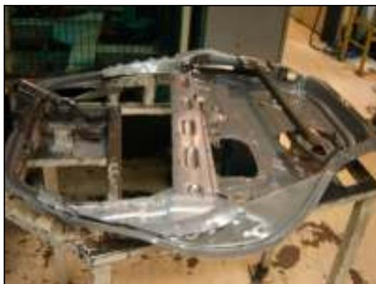
Figura 1.2 - Imagem de um painel interno da porta traseira do Celta
