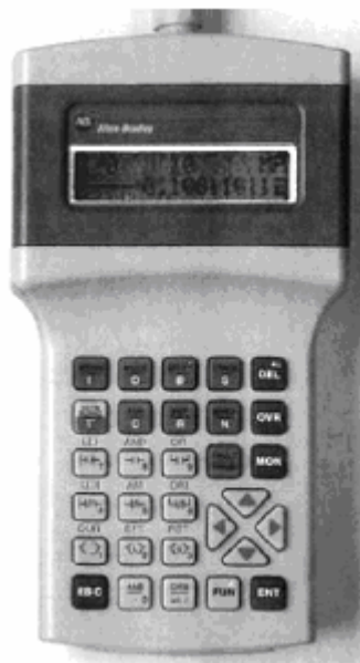
Figura 4: Foto de um programador manual de CLPM. 3
