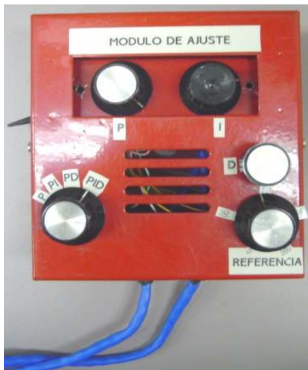
Figura D3 – Módulo de ajuste do controlador P, PI, PD, PID.
