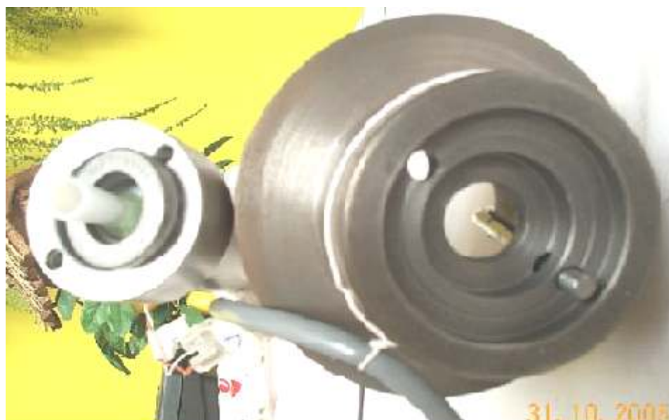
Figura 3.13 - Instalações do sensor na abertura da base.
