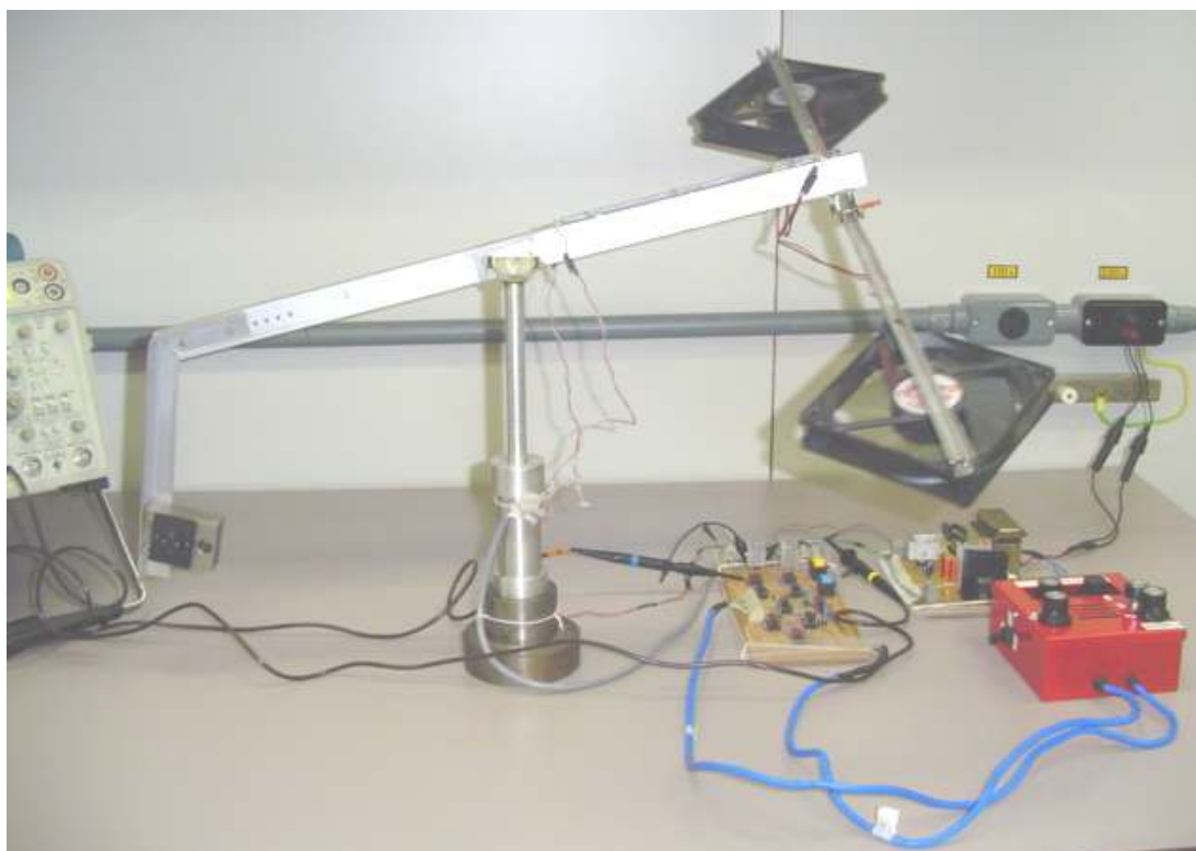
Figura 3.22 – Posição angular do sistema de propulsão sendo controlada por um PID analógico.
