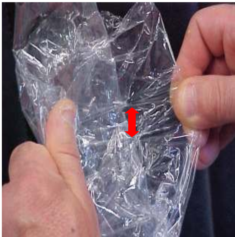
Figura 3.9 – Detalhe do filme soldado à temperatura de 120° C em 4 segundos.
