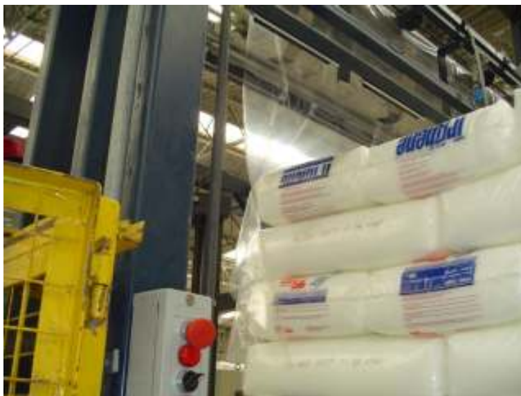
Figura 3.21 – Detalhe do filme de cobertura sendo cortado.
