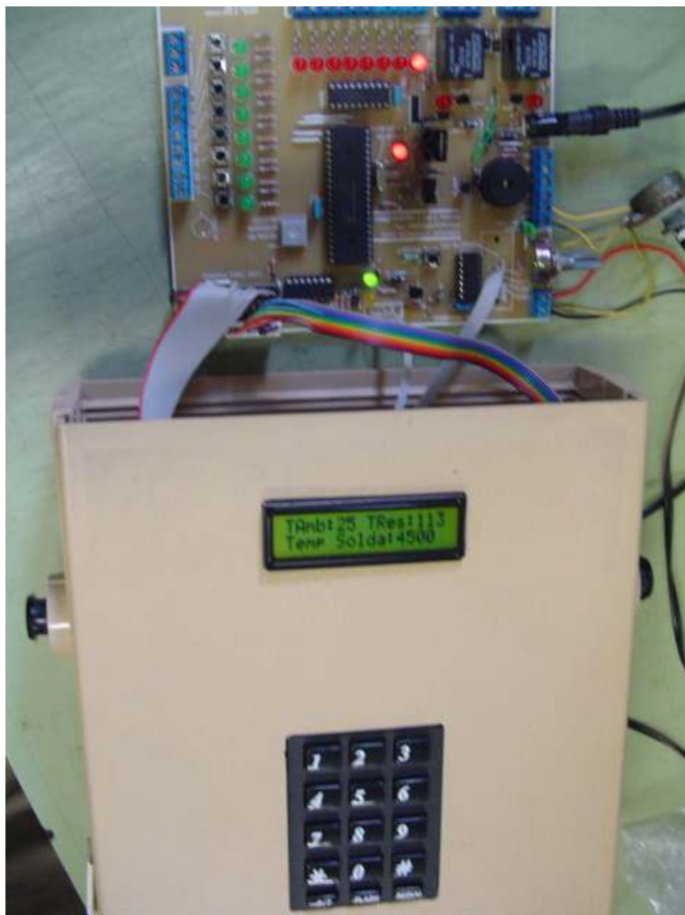
Figura 4.5 – vista do sistema microprocessado, utilizado para controle do processo.
