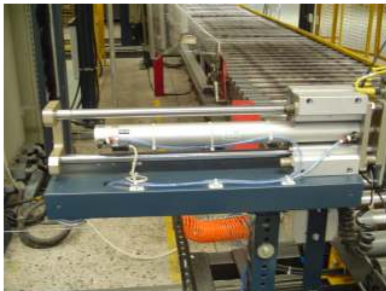
Figura 3.25 – Pistão pneumático de acionamento das resistências elétricas.
