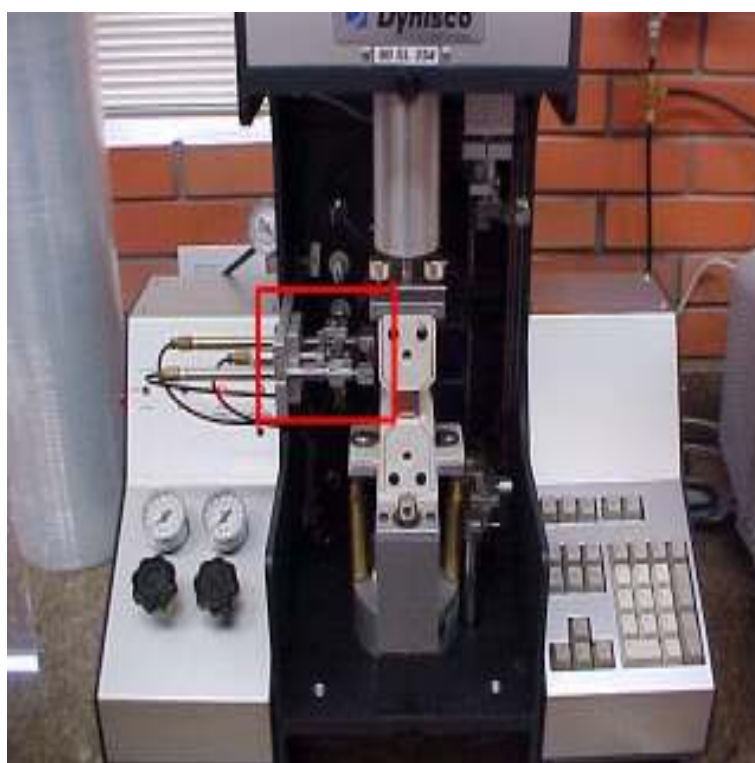
Figura 3.6 – vista, em destaque, dos grampos que prendem o filme a ser soldado.
