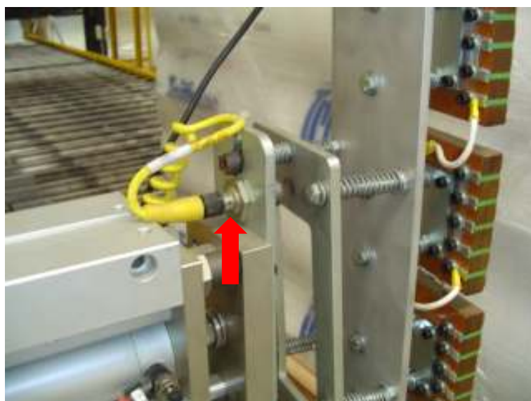
Figura 4.4 – Destaque do sensor indutivo identificando a adequada aproximação do bloco de resistências no filme de polietileno.
