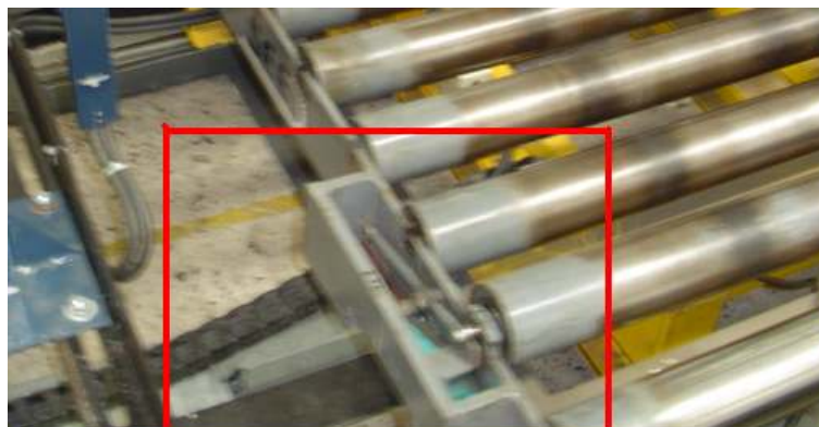
Figura 4.1 – Destaque do sensor indutivo colocado no último rolete da esteira.
