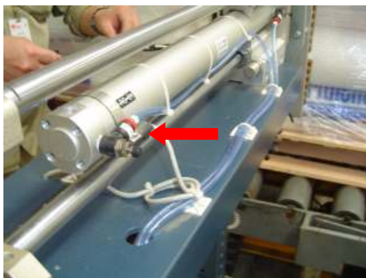
Figura 4.2 – Destaque do sensor micro switch indicando fim de curso do pistão pneumático.
