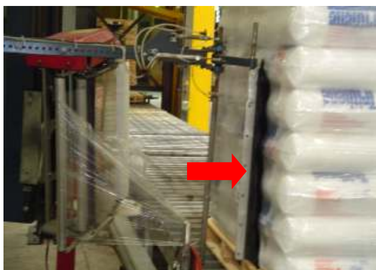
Figura 3.23 – Destaque da vassoura que acomoda o filme em torno do bloco.
