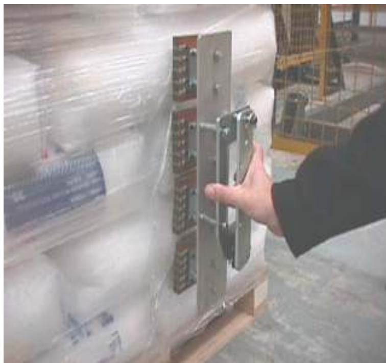
Figura 3.3.a – Resistências Articuladas em contato com o palete.
