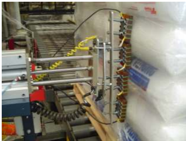
Figura 3.3.b – destaque da flexibilidade, para a solda, adquirida com as resistências articuladas.
