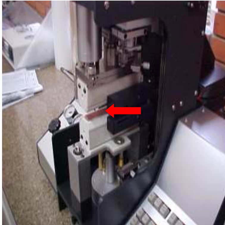
Figura 3.5 – máquina de soldagem, destacando as barras de aquecimento.
