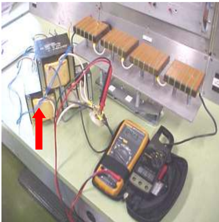
Figura 3.7 – Banco de transformadores (110 VAC – 15 VAC) acoplados no sistema.
