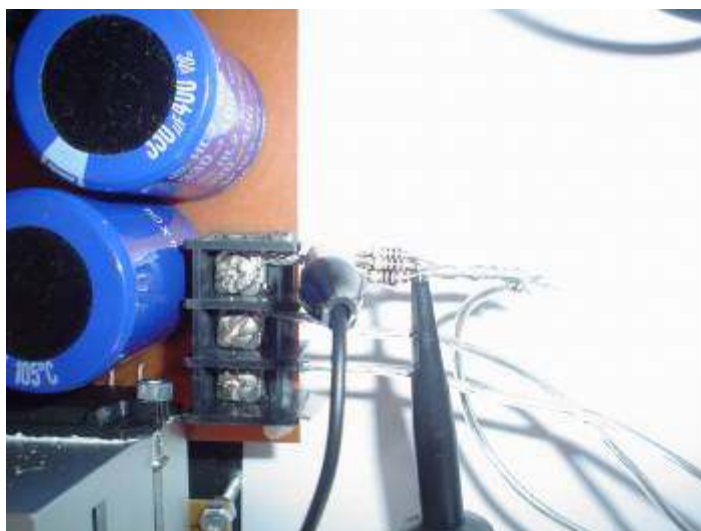
Figura 50 - Ponta do osciloscópio conectada sobre os resistores
