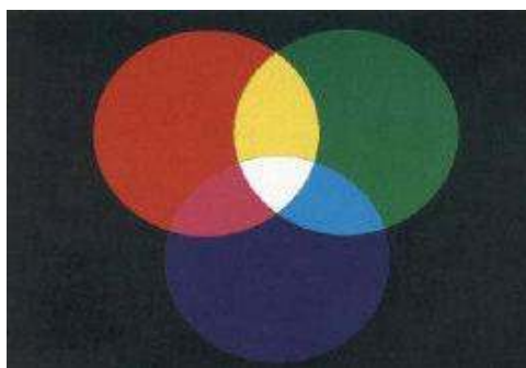
Figura 2.3 – Processo aditivo das cores primárias.
