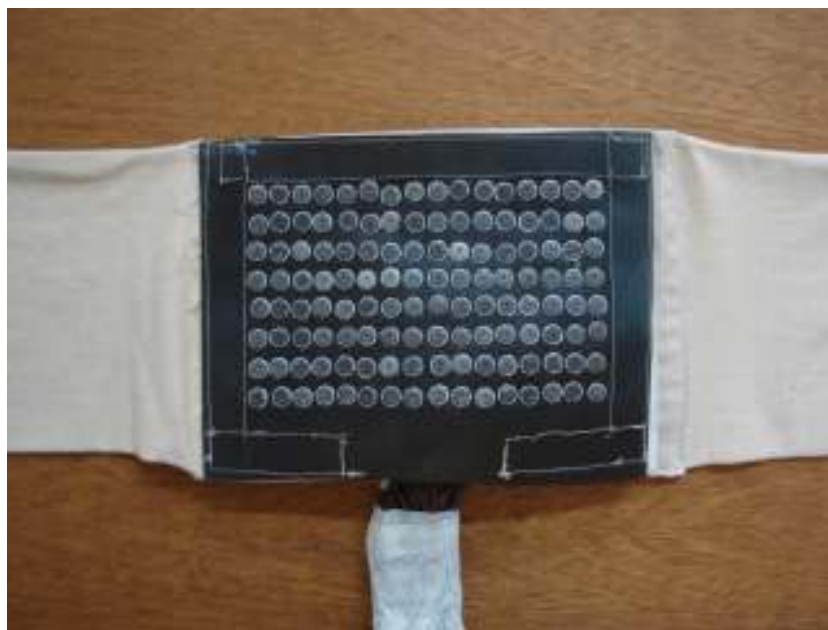
Figura 3.21 – Cinta com a matriz de eletrodos vista frontal.
