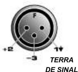
PINAGEM DO CONECTOR XLR NORMA IEC 268
