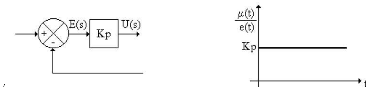
Figura 16 - Diagrama em blocos e gráfico da ação proporcional. Fonte: Hey, (1997).
