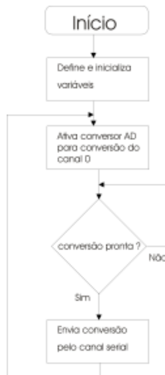
Figura 23: Fluxograma do programa executado no PIC16F72.
